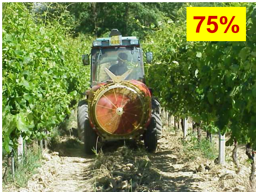
irroratrici ad aeroconvezione (polverizzazione per pressione)
