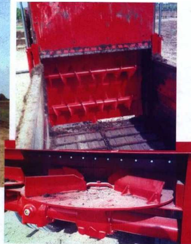
SISTEMA A ROTORI ORIZZONTALI E PIATTI CENTRIFUGHI
