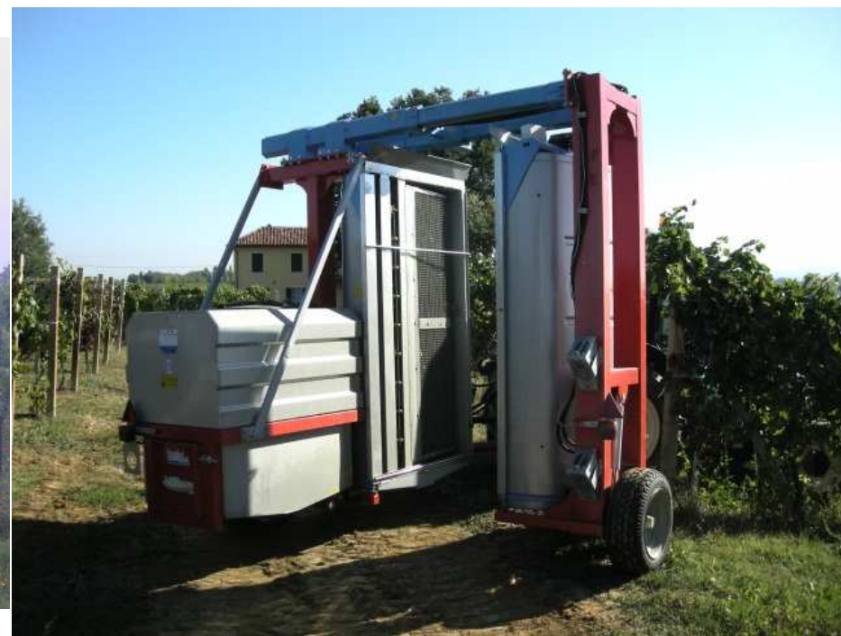
Irroratrici a tunnel con recupero della miscela fitoiatrica
