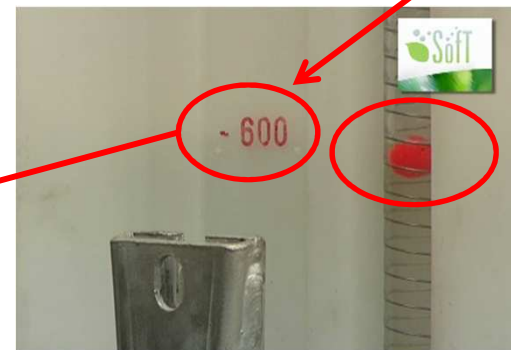
Indicatore del livello del liquido presente sul serbatoio della macchina
