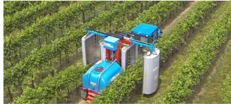
Sistemi a tunnel con carica elettrostatica
