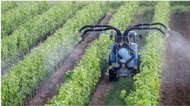
Sistemi a tunnel con recupero della sostanza fitoiatrica con vortice d'aria
