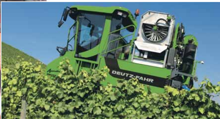
Le nuove vendemmiatrici semoventi Agrovitis 150-175-200 sono equipaggiate di motore Deutz 2012 a 6 cilindri da 6.057 cc turbo intercooler ed omologate per la circolazione su strada a 40 km/h/SDF's new self-propelled Agrovitis 150, 175 and 200 grape harvesters are powered by a Deutz 6-cylinder 6,057 cc engine with turbo intercooler, registered for highway use up to 40 km/h
