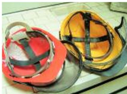
Modelli di casco completi di cuffie e visiera. L'interno dei caschi contiene una struttura che garantisce alla testa di non trovarsi a diretto contatto con la plastica rigida dell'elmetto. In questo modo si ottiene una duplice funzione: di isolamento dagli urti e di ricircolo di aria/*Helmets with ear muffs and visors. Helmets have a structure inside to ensure that the head does not come into direct contact with the outer skin of rigid plastic, to give isolation from shocks and air circulation*
